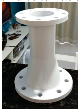
Figura 74 – Peça central do barrilete em plástico PLA
