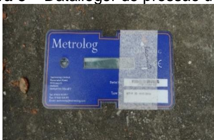
Figura 8 – Datalogger de pressão utilizado
