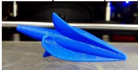
Figura 53 – Rotor ajustado e impresso (longitudinal)
