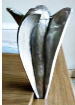
Figura 76 – Rotor fundido em liga de alumínio
