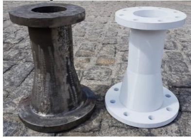
Figura 75 – Peça central fundida em ferro
