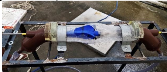
Figura 61 – Peça central do barrilete rompida
