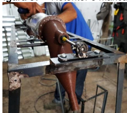
Figura 57 – Retentor e mancal sendo montados
