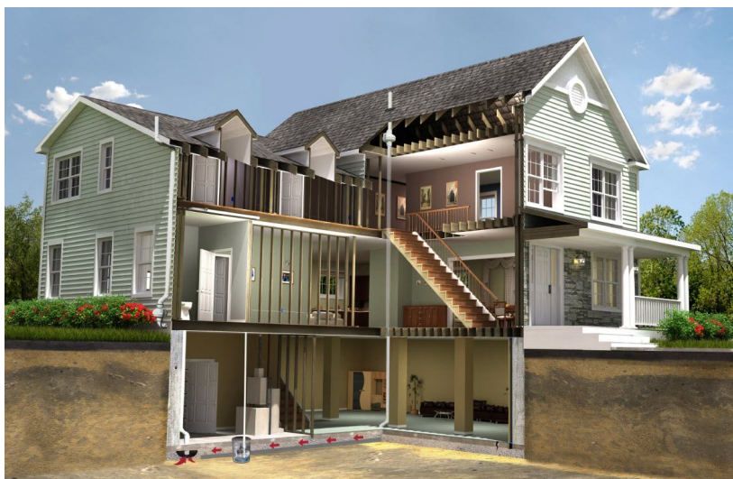
Figura 5 - Sistema mitigatório passivo de correção em imóveis para presença verificada ou potencial de radônio
