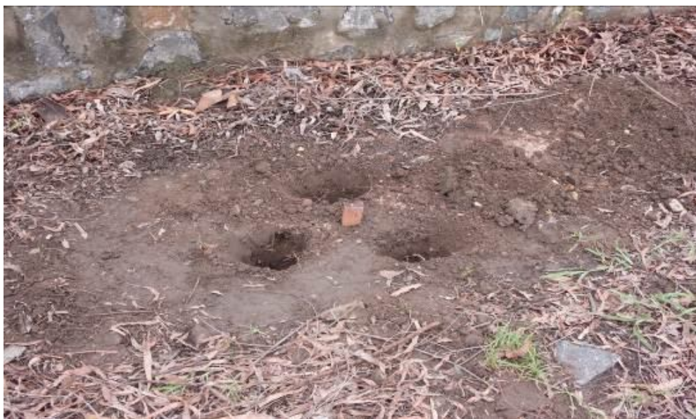
Figura 5. Detalhe do ponto de coleta no entorno da mineradora: retirada de amostras 0,0 a 0,1m e 0,2 a 0,3m.
