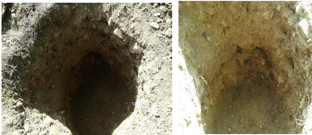
Figuras 2 e 3: Abertura da trincheira para identificação e classificação do solo no entorno da mineradora. Muritiba-Ba, 2016.
